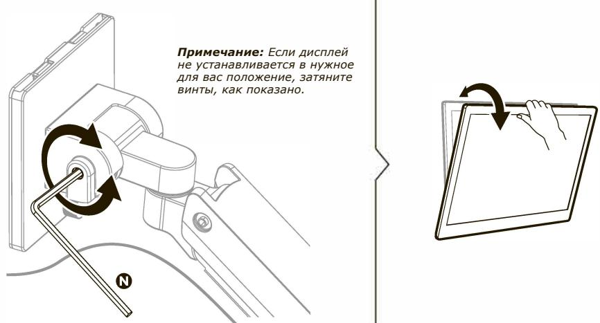
Чтобы правильно отрегулировать кронштейн с установленными мониторами, отрегулируйте натяжение пружины с помощью прилагаемого шестигранного ключа следующим образом:
